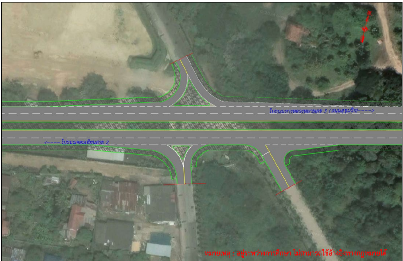
รูปที่ 4 ตัวอย่างรูปแบบทางแยกบริเวณจุดตัดระหว่างถนนโครงการกับถนนซอยเทพประสิทธิ์ 9
